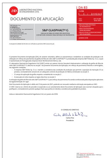
O Documento de Aplicação (DA) com a referência DA 83, emitido pelo Laboratório Nacional de Engenharia Civil (LNEC) para a Grelha de Fibra de Vidro, avalia as características da grelha, as condições de produção e de utilização em reforço de pavimentos.
