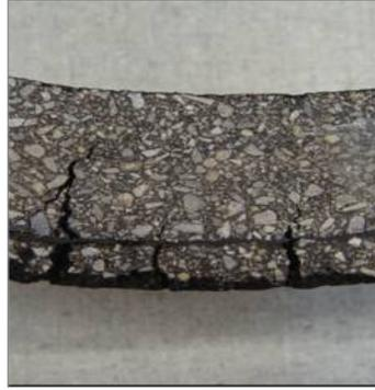
Figura 2. Provede reforçado com S&P Carbophalt® G
